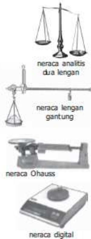
Gambar 1.14 Jenis-jenis neraca untuk mengukur besaran massa.
